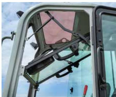
Vetro superiore frontale con apertura a scomparsa, dotato di un meccanismo ergonomico di apertura/chiusura e tettuccio antiriflesso con tendina parasole di serie.
