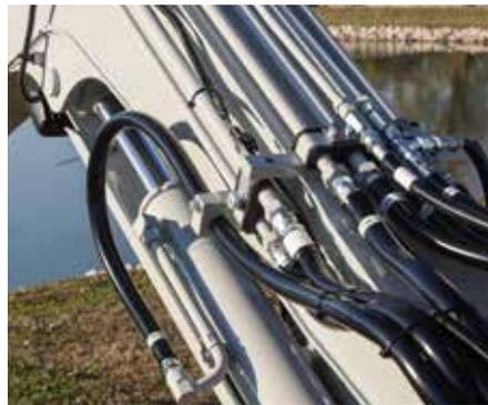
Linee idrauliche in acciaio e morsetti di sostegno in gomma e metallo.
