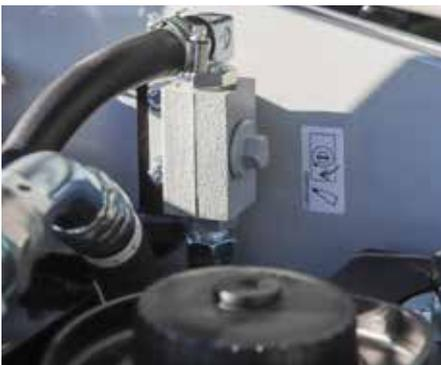
Il selettore 1-2 vie è posizionato sopra il serbatoio di olio idraulico.
