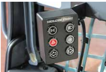
PULSANTIERA CIRCOLAZIONE STRADALE
