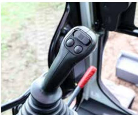
I sistemi ausiliari sono dotati di comandi proporzionali di serie per un controllo perfetto delle attrezzature installate.
