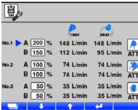
Tramite il computer di bordo è possibile aumentare o diminuire la quantità di olio al sistema ausiliario.
