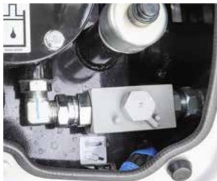
Rubinetto selettore impianto ausiliario doppio effetto (trinchia) o singolo effetto (martello con scarico diretto a serbatoio).
