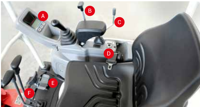
Per modificare le portate impostate accendere il quadro tenendo premuto il pulsante C, poi cliccare A per entrare in SETTING.
