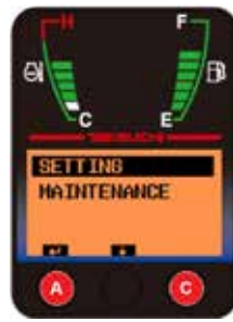
Per modificare le portate impostate accendere il quadro tenendo premuto il pulsante C, poi cliccare A per entrare in SETTING.
