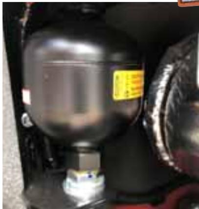
**QUALITÀ EVIDENTE** L'accumulatore di pressione metallico assicura lunga vita dell'impianto assorbendo sovra pressioni della linea servocomandi. In caso di anomalie, permette di appoggiare sempre il braccio a terra.
