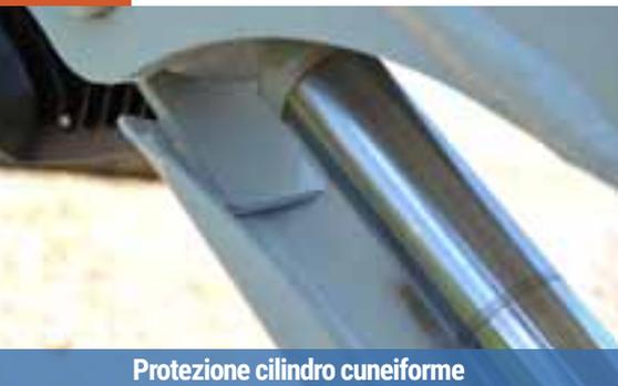
Protezione cilindro cuneiforme
