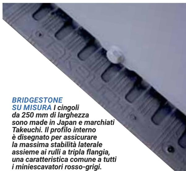
**BRIDGESTONE SU MISURA** I cingoli da 250 mm di larghezza sono made in Japan e marchiati Takeuchi. Il profilo interno è disegnato per assicurare la massima stabilità laterale assieme ai rulli a tripla flangia, una caratteristica comune a tutti i miniescavatori rosso-grigi.
