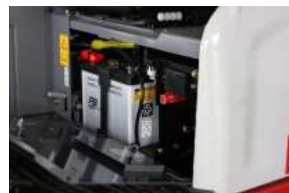
Batteria posizionata nel vano sotto il sedile.
