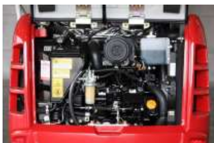
Ampio cofano apribile a 90°. Facile accesso al radiatore per la pulizia.
