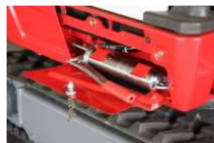
Sacca portattrezzi e pistola ingrassatrice posizionata in un comodo vano protetto da chiave.
