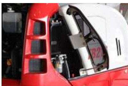
Botola laterale per un comodo accesso al separatore acqua e per la pulizia del radiatore side-by-side olio idraulico e liquido refrigerante.
