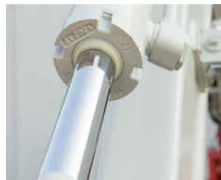
Cilindri idraulici ammortizzati dotati di guarnizioni antipolvere.
