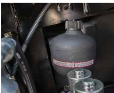
L'accumulatore è una sacca contenente gas inerte (azoto), quando la pressione all'interno dell'impianto è costante la sacca occupa tutto il volume dell'accumulatore, quando la pressione all'interno dell'impianto diminuisce, la sacca si comprime. I benefici di questo dispositivo sono riportati di seguito:
