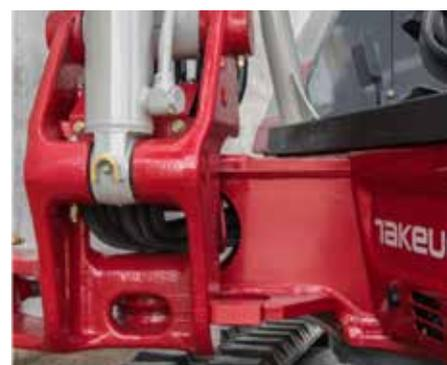
Swing stop di serie, obbligatorio per benne con larghezza superiore a 46 cm, a tutela della sicurezza operatore.
