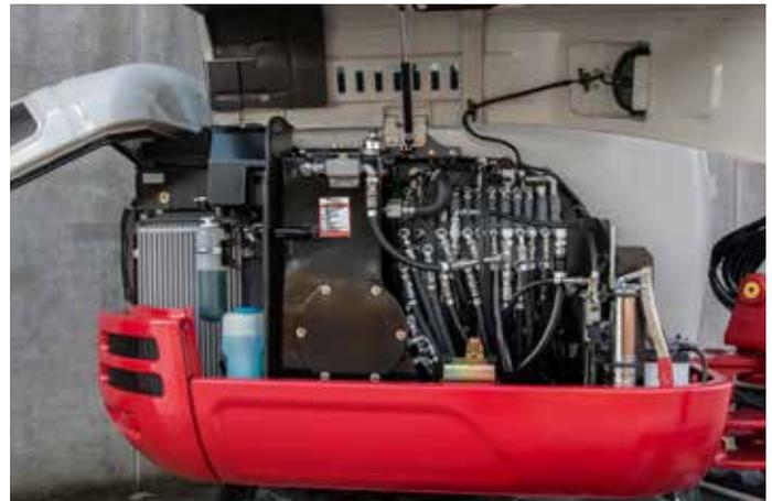
Takeuchi utilizza olio idraulico Long life con sostituzione prevista dopo 4.000 ore di lavoro. Il sistema è progettato per la massima affidabilità: all'interno del serbatoio idraulico, un filtro di ritorno di alta qualità, garantisce l'assenza di impurità all'interno del circuito. Ogni macchina Takeuchi prima di essere venduta subisce un rigoroso lavaggio dell'impianto idraulico, che elimina ogni impurità che potrebbe essersi depositata durante la fase di assemblaggio.
