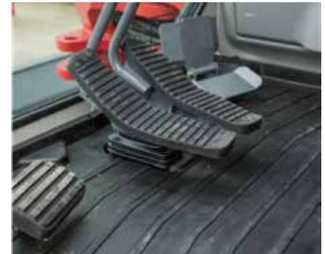
2 velocità di avanzamento. Pedali con rivestimento in gomma che consentono la traslazione senza l'utilizzo delle mani.
