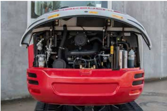
Nel vano motore ogni elemento è posto ad altezza uomo e gli interventi di manutenzione risultano rapidi e facili da eseguire. Nella parte inferiore della torretta si trovano i tappi per lo spurgo dell'olio idraulico, dell'olio motore, del liquido refrigerante e del gasolio, per facilitare gli interventi di pulizia e assistenza. L'apertura laterale dei carter ad ali di gabbiano permette un accesso facile anche ai principali componenti idraulici come il distributore o il serbatoio olio idraulico.
