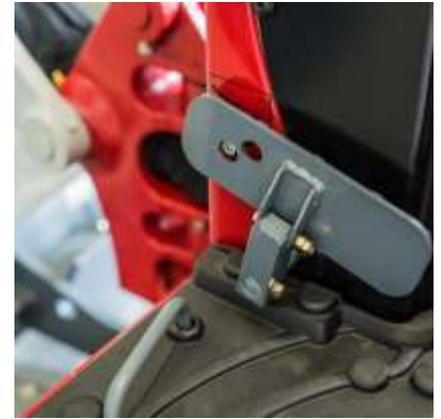
Doppia asola per posizione di riposo e posizione attiva, per il comando di attrezzature ad azionamento manuale.
