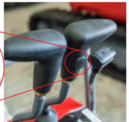
Pulsante seconda velocità sulla leva di traslazione destra
